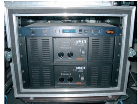
A amplificação e o processador que controlava parte do line array LS3/550.
